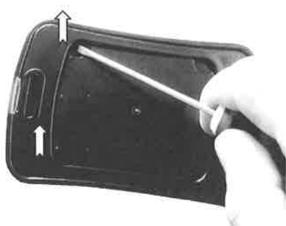
Per togliere il supporto di fissaggio dal dispositivo, agire con un cacciavite come mostrato in figura.
